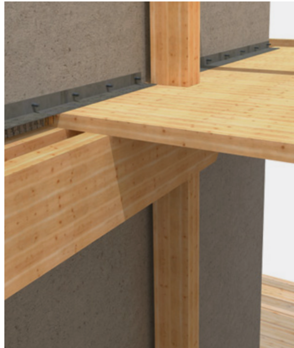
↑ Fig. 2: Détail de connexion de la structure de bois au mur de refend en béton Connection detail between the wood structure and the concrete shearwall
